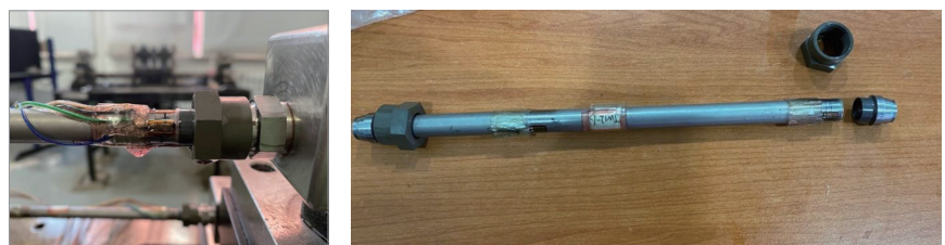
(a) 导管与管套之间渗漏
